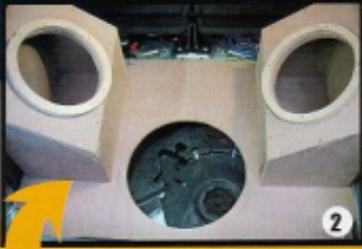
Les choses se compliquent. Avant tout, il aura fallu regarder les conseils du fabricant ou réviser vos notions d'acoustique pour créer les deux caissons de charge des deux subwoofers utilisés. Ici, ce sont des volumes clos de 20 litres, pas très compliqués à fabriquer, à partir de panneaux de médite. Le fond et les deux caissons sont fabriqués bien sûr à part, puis réunis.
